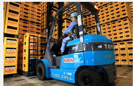
Carretillas elevadoras que funcionan a base de hidrógeno junto a Toyota Material Handling
